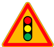
PANNEAU DE SIGNALISATION AK17 FEUX TRICOLERE
